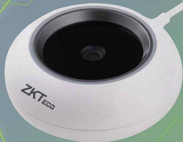
O **PV10R** é um leitor sem toque projetado para leitura qualificada de palma de veia das mãos, via luz de preenchimento de infravermelho, graças ao sensor de imagem dinâmica e um sistema ótico de câmera sem distorção esférica.
